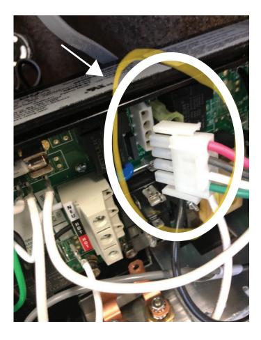
4 Enlevez le connecteur qui est branché dans la carte électronique et serrez avec les doigts les ailettes de chaque côté de l'embout blanc afin de l'enlever facilement (connexion de la pompe);
